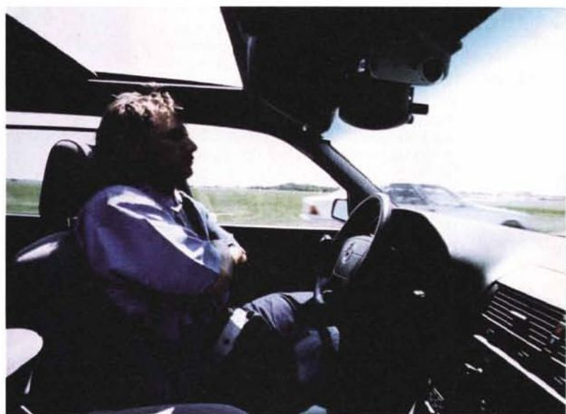
Figure 11 e 12 - La Mercedes 500 su cui è montato il sistema VITA II sembra non avere molto di diverso da una comune auto berlina, se non fosse per la telecamera sul parabrezza anteriore e lo stile di guida... un po' disattento. In figura abbiamo poi una schematizzazione delle componenti del sistema: 1) motore elettrico per l'azionamento dello sterzo; 2) sistema automatico di frenaggio; 3) dispositivo di variazione intelligente della velocità; 4) telecamere anteriori; 5) telecamere posteriori; 6) Transputer Image Processor dotato di 60 processori paralleli; 7) sistemi di controllo; 8) 2 PC come interfaccia uomo-macchina; 9) sistema di navigazione; 10) giroscopio e GPS.
